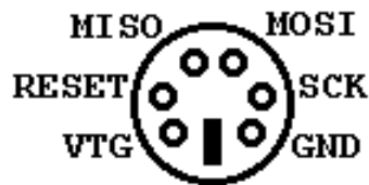
Mini-DIN 6 Buchse von hinten
